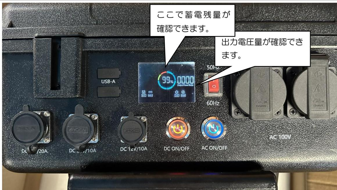
本体の出力口に電気製品を接続します。
